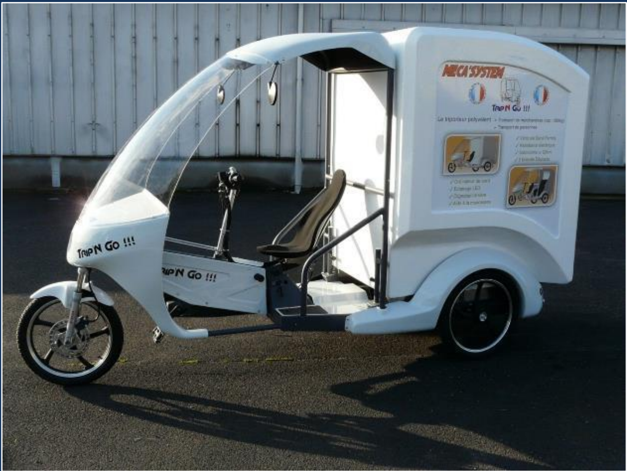
Mobilier urbain, Tricycle à assistance mécanique, carrosserie réalisée par SNEP en pièces thermoformées
