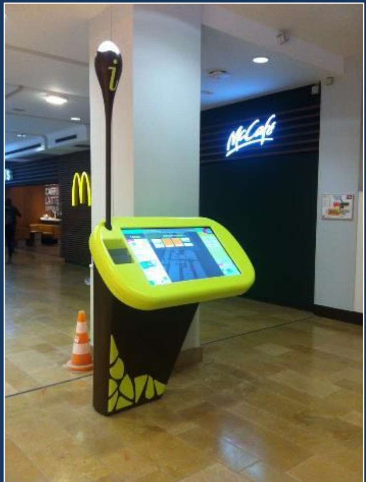
borne thermoformée à écran tactile Centre commercial les Halles Strasbourg
